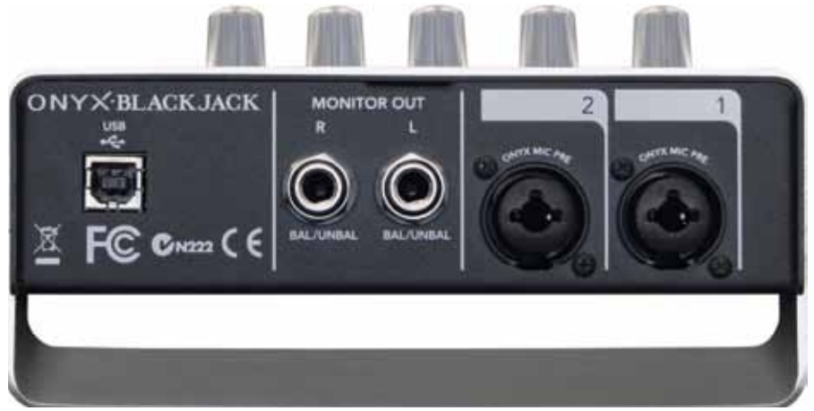
Übersichtlich und aufgeräumt: Eingangsseitig sind XLR-/Klinken-Combibuchsen integriert.
